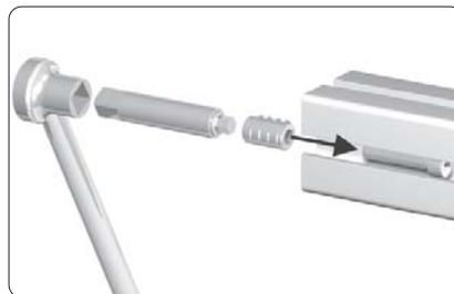
Inserer la vis à tête cylindrique et l'insert dans la rainure
