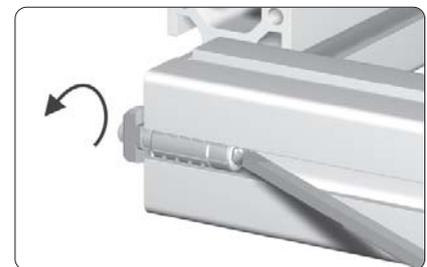
Pré-assemblage d'écrou 1/4 tour
