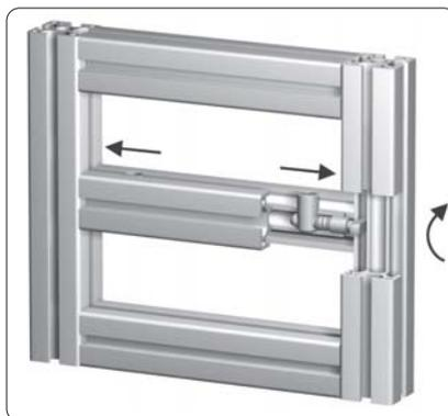
4. Desserrer la vis sans tête; la pièce d'ancrage se trouve alors poussée dans la rainure par le ressort. Faire tourner la tête d'ancrage de 90°, à l'aide d'un tournevis. Resserrer la vis sans tête.
